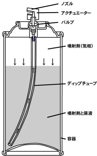
原液と液状の噴射剤を容器に充填し、バルブを取り付けると、常温下において液化ガスの一部が蒸発して容器内で圧力が生まれます。そして、バルブを押すことで、この液化ガスの蒸気圧力により液相（原液と液化ガスの混合液）が放出されます。この時、アクチュエーターのノズルによって液相が粉碎され、同時に液化ガスの急激な膨張によって、細かい霧となって空間に放出されます。
