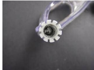
詰まりが発生したハウジング
