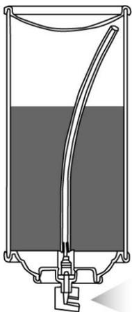
缶を逆さまにして3秒ほどボタンを押して下さい。そうすることで、チューブ内に残っている塗料が排出され、ガスだけが出るようになります。
