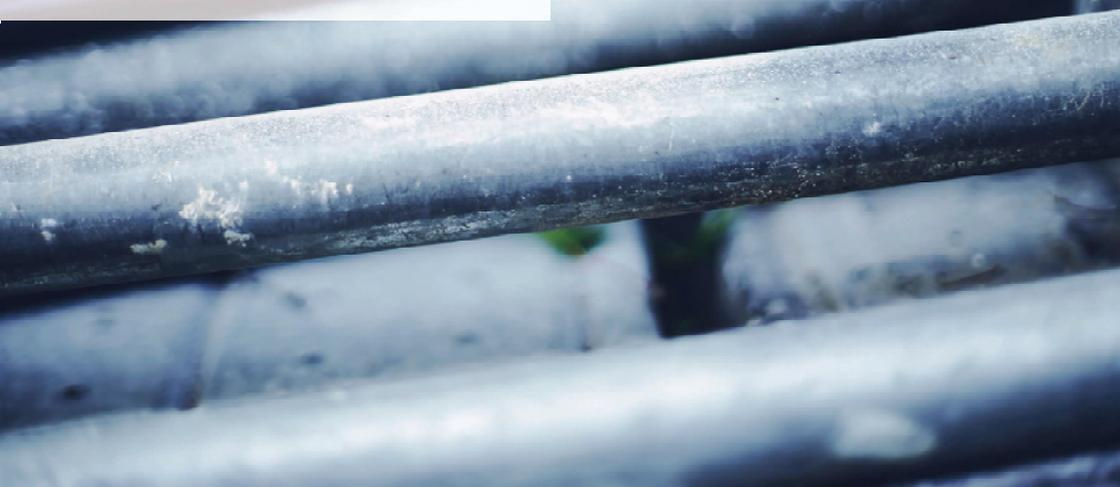
白さびは溶融亜鉛めっきの保管方法などが原因で発生します。“さび”と名前がついていますが、正式には「塩基性炭酸亜鉛」です。「白さび」という名称と見栄えがあまり良くないこともあり、「赤さび同様、腐食を促進させるもの」というレッテルが貼られています。
