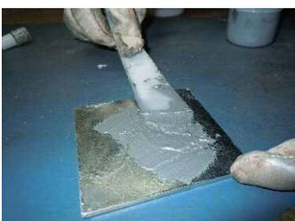
へこみ補修時は、補修部へ埋め込むように塗布後、少し多めに肉盛りした方が、後の作業がやりやすくなります。
