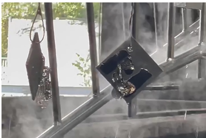
めっきガードを塗布した箇所が完全に剥離し、黒皮面が露出しているのが分かります
