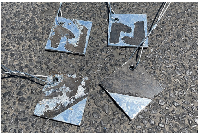
めっき直後の状態です めっきガードを塗布していた部分はめっきが付着していません
