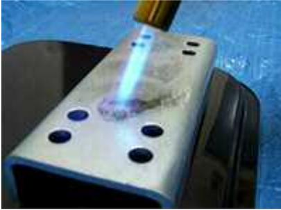
◆本製品は、320℃で溶けますので、約 350℃くらいまで、ガスバーナー、トーチランプ等で鋼材を加熱します。
