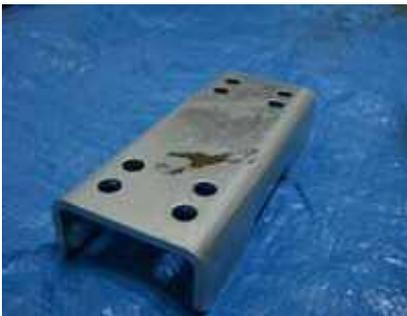
◆不めっき箇所の補修の際には、さびを完全に落としていただく必要があります。写真は、熔融亜鉛めっきされた部材の不めっき箇所の補修です。
