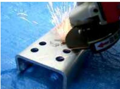
◆施工部をグラインダー、サンダー、ジェットタガネ、サンドペーパー等を使用し、スケール、スラグ、赤さびの汚れを除去して下さい。その際、少しの黒皮が残っている状態でも溶着します。
